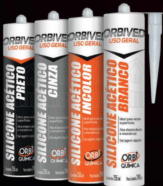
É um adesivo de silicone para uso geral flexível de cura acética, ideal para reparar uma grande variedade de materiais como vidros, metais, madeira, alumínio, policarbonato e outros. Forma película em aproximadamente 10 minutos e cura total em 24 horas. Possui alto alongamento e baixa tensão a ruptura. **IMPOR-TANTE:** Não é recomendado para uso em aquários.
